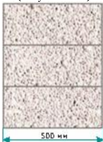
Автоклавный газобетон плотностью D500
